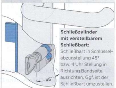
**Schließzylinder mit verstellbarem Schließbart:**
